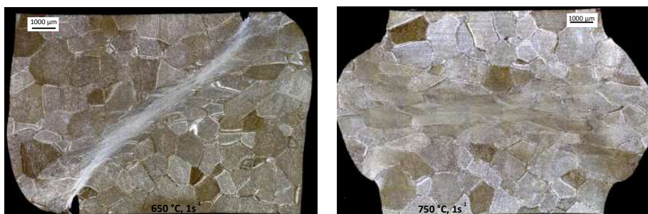
FIGURE 2.18 – Observation par microscope optique des échantillons de Ti17 \alpha + \beta après déformation à \dot{\epsilon} = 1 \text{ s}^{-1} et a) T=650^\circ\text{C} b) T=750^\circ\text{C} .
