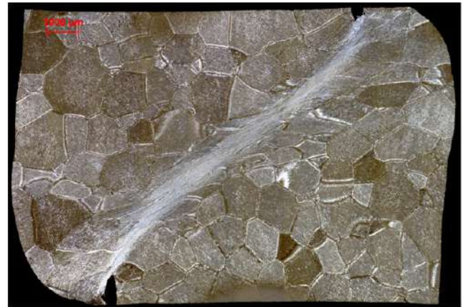
FIGURE 5.25 – Observation métallographique des éprouvettes après déformation à 600^\circ\text{C} et à 0,1 \text{ s}^{-1} (à gauche), 1 \text{ s}^{-1} (au centre) et 10 \text{ s}^{-1} (à droite).
