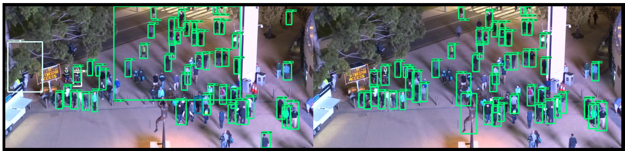
FIGURE 23 – Comparaison d’une détection d’une foule par le détecteur témoin (gauche) et par le détecteur entraîné (droite). On constate que le détecteur entraîné ne détecte plus les foules comme un individu unique.
