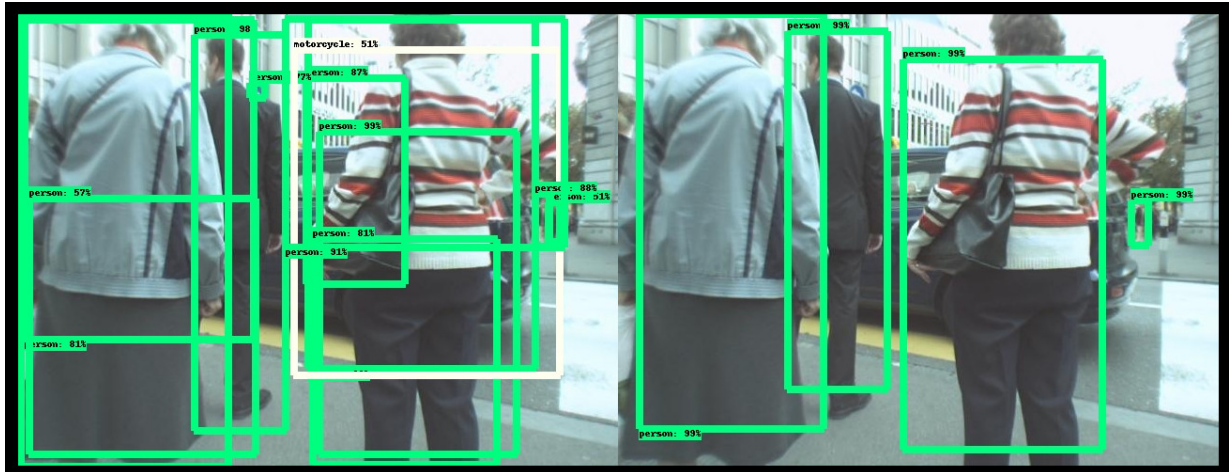
FIGURE 22 – Comparaison d’une détection d’un ensemble de cibles proches de l’objectif par le détecteur témoin (gauche) et par le détecteur entraîné (droite). On constate que le phénomène de subdivision des bounding boxes qui apparaît dans les détections du détecteur témoin n’apparaît pas dans les détections du détecteur entraîné.
