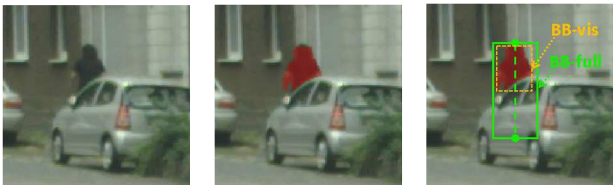
FIGURE 26 – Exemple d'annotation sur le dataset Citypersons. A partir de l'image d'un piéton (gauche), le masque du piéton est annoté (milieu) puis les bounding boxes de sa partie visible (à droite, en jaune) et de son contours complet (à droite, en vert) sont annotés. Source : [63]
