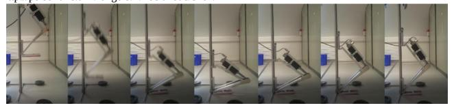
Afin d'obtenir de bonnes performances, la géométrie du robot doit être optimisée. Autrement dit, il est nécessaire d'accrocher les moteurs aux meilleurs endroits sur la structure du robot tout en gardant une géométrie ressemblant à une jambe humaine. D'un point de vue académique, ce problème se formule donc comme un problème d'optimisation sous contraintes.
