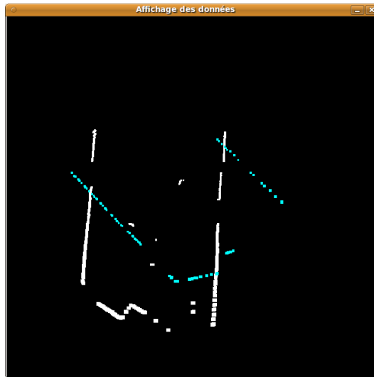
FIG. 4.7 – Avant l’algorithme de recalage. Le jeu blanc correspond au modèle et le jeu bleu à la scène.
