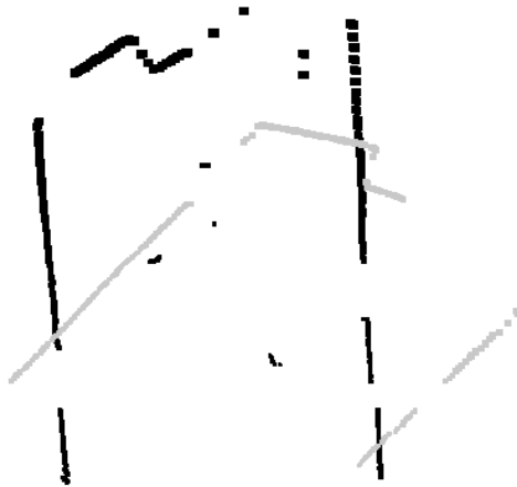
FIG. 3.2 – Deux scans faits à l'aide d'un URG-04LX. En recalant le jeu gris sur le jeu noir on aura une estimation du déplacement effectué entre les deux scans.
