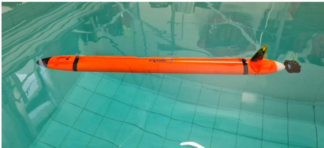
Figure 32 – Photo du Riptide dans le bassin de l'ENSTA Bretagne durant la phase d'équilibrage
