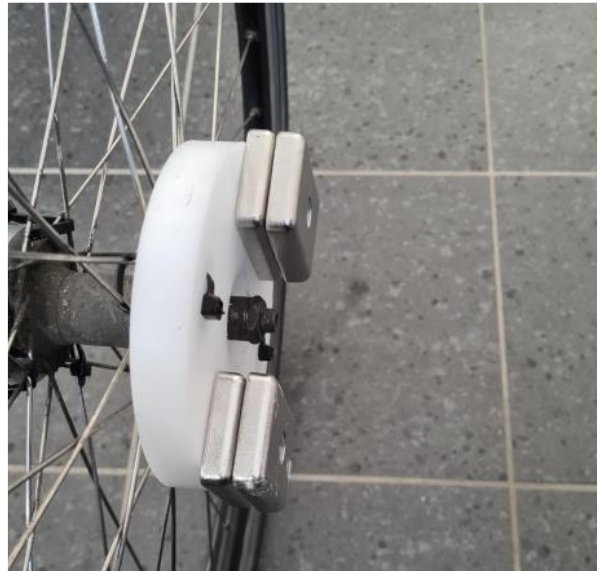
Figure 15 – Image du système d'équilibrage de la V0
