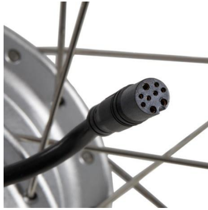
Figure 24 – Image du câble d'alimentation du moteur de la roue de vélo électrique
