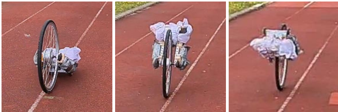
Figure 30 – Images du démonstrateur durant le réglage des coefficients du contrôleur PID
