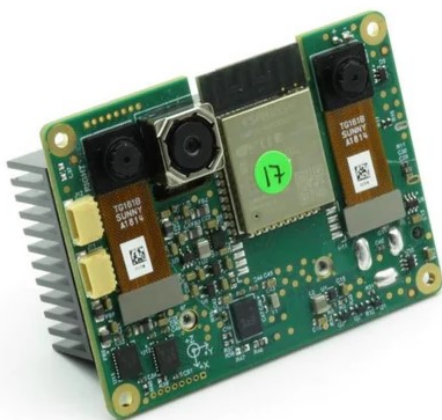
FIGURE 2.1 – Caméra Luxonis OAK-D-IoT-40. Taille : 60 mm de large, hauteur 45 mm, largeur 25 mm ; masse : 45,5 g sur sa documentation technique.
