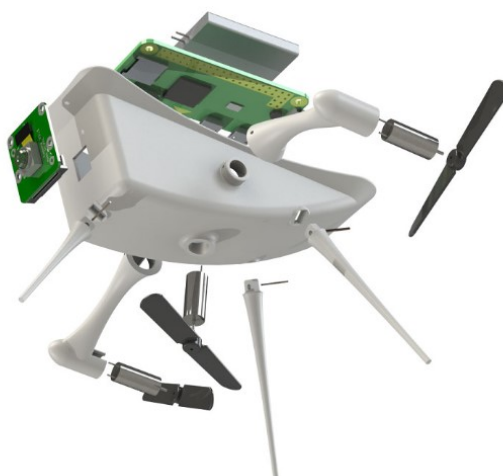
FIGURE 1.9 – Nacelle en impression 3D du minidirigeable [6]
