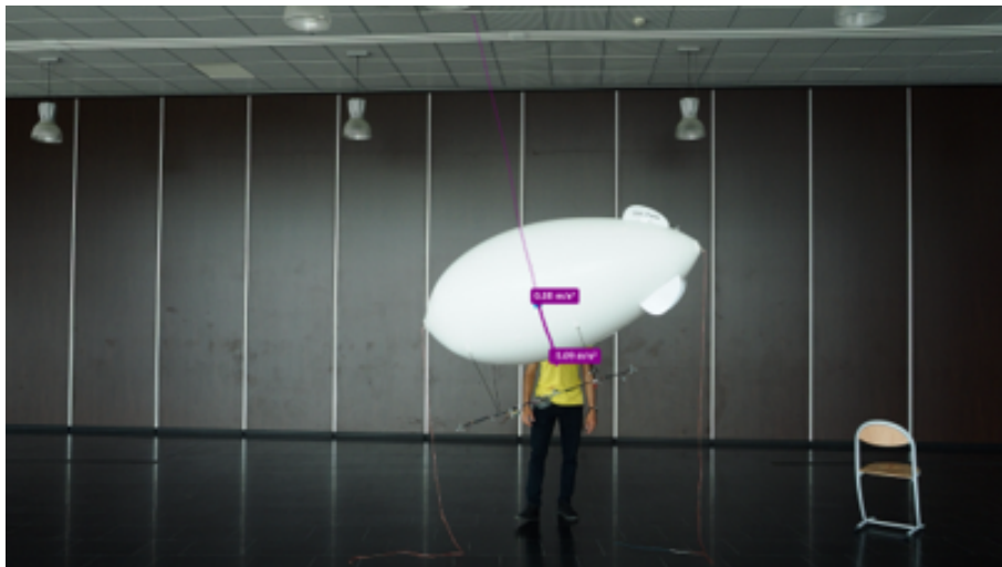
FIGURE 2.6 – Suivi du minidirigeable dans une translation suivant z .
