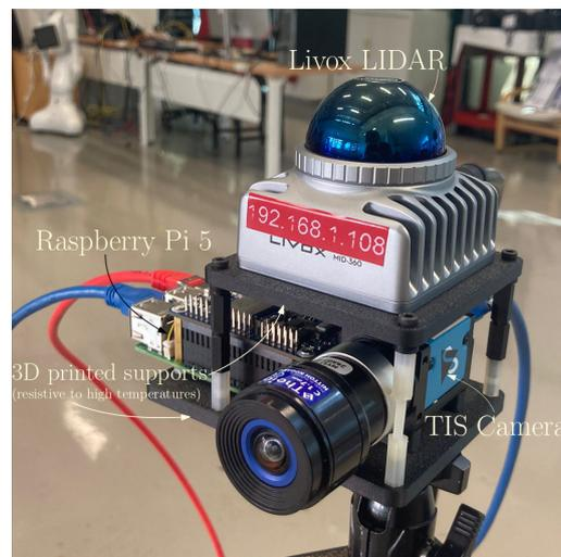
FIGURE 3.26 – Un module expérimental combinant un LIDAR, une caméra et une Raspberry Pi
