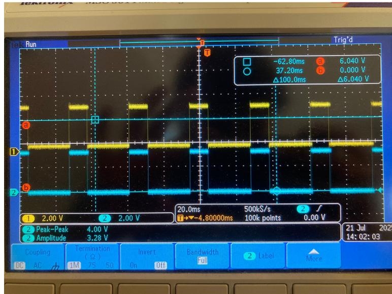
FIGURE 3.23 – Preuve de la synchronisation entre deux Raspberry Pi en observant à l'oscilloscope des signaux envoyés à des instants précis
