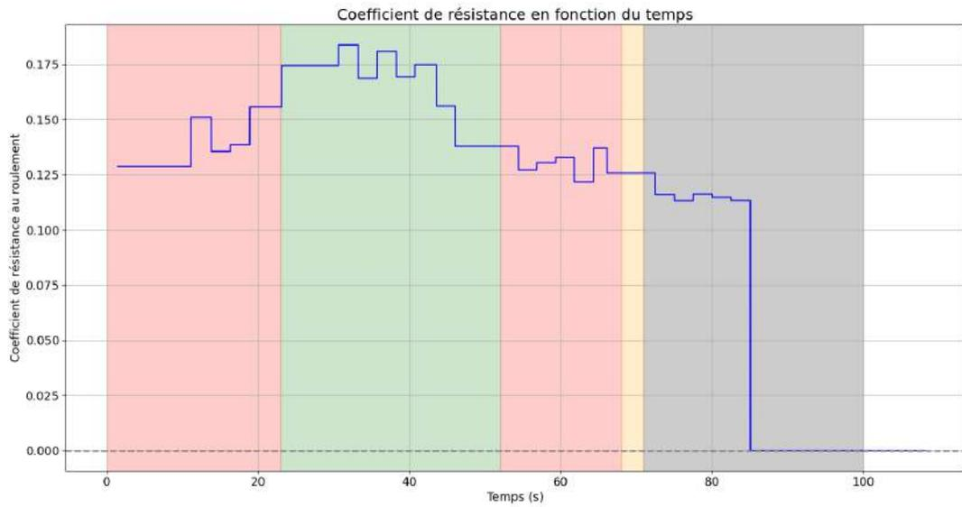
FIGURE 5.7 – Coefficient de résistance au roulement sur le rosbag de l’essai 8.
