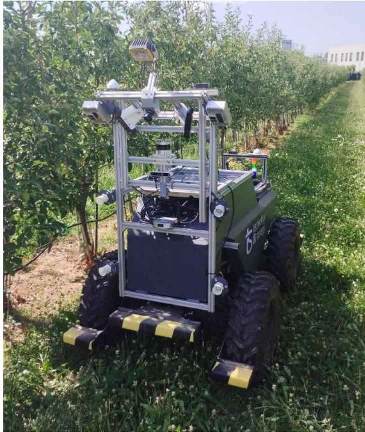
FIGURE 1.2 – KIPP, la plateforme expérimentale tout-terrain de Innolab.
