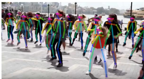
Figure 1 : Détection du squelette par vision et apprentissage profond (source : <https://www.youtube.com/watch?v=pW6nZXeWIGM>)
