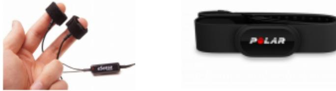
Figure 12 : Capteurs physiologiques a : à gauche GSR b :à droite ECG
