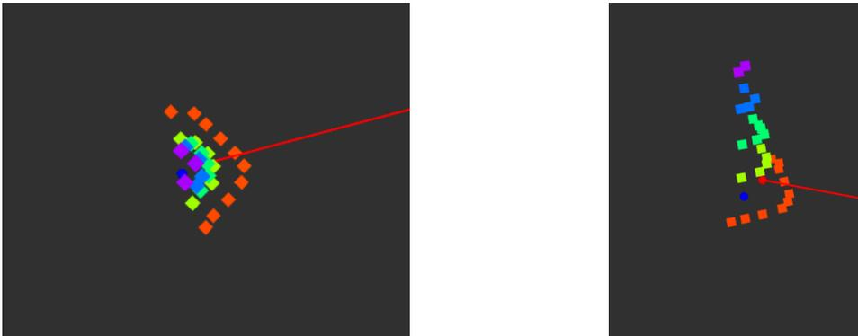
FIGURE 4.6 – Le nuage de points associé à un amer ne nous fournit d'information que sur la face exposée du cône
