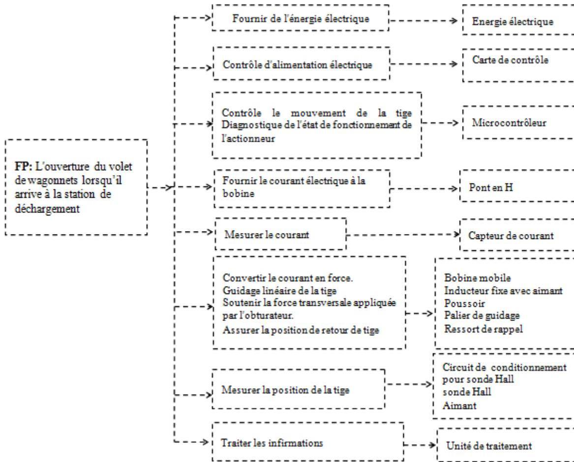
Figure 4.17: Diagramme FAST de l’actionneur intelligent
