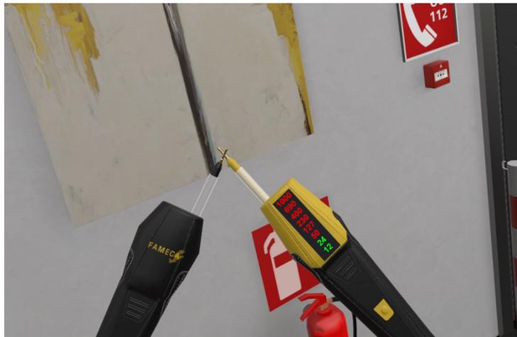
FIGURE 4.4 – Illustration d'un outil spécifique, DDT, demandant une gestuelle obligatoire et nécessaire pour une activité de réparation de prise électrique.
