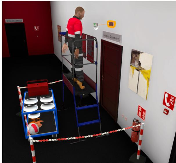
FIGURE 3.10 – Avatar de l'utilisateur présent dans une zone à risques dans un scénario d'habilitation électrique. Il n'est pas possible pour un agent incarné d'être présent dans la même zone. Pour avoir de l'assistance, l'apprenant doit donc descendre de la gazelle et naviguer vers l'agent pédagogique qui est à l'extérieur de la zone de travail.
